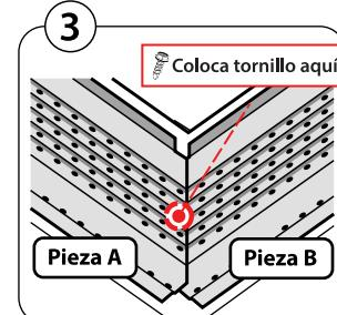
Así se ve una esquina terminada. Para un instalación con mejor sellado, coloca un tornillo a través de ambas piezas.
