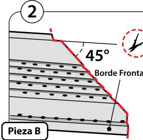
Corta la punta de la Pieza B adyacente a  $45^{\circ}$  de forma opuesta. Repite los dos cortes pequeños de  $1/2"$  en el ala trasera y de  $3/4$  a  $1"$  en el borde frontal.
