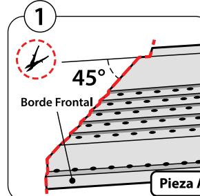
Haz un corte de  $45^{\circ}$  en la punta de la Pieza A. Despues, haz un pequeño corte de  $1/2"$  en el ala trasera. Por ultimo, haz un corte recto de  $3/4$  a  $1"$  desde el borde frontal hacia el centro.
