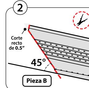
Corta la punta de la Pieza B a  $45^{\circ}$ , despues haz un pequeño corte recto de  $1/2"$  en el Ala Trasera. Coloca la Pieza B encima de la Pieza A y verifica que no haya espacio entre ambas piezas.
