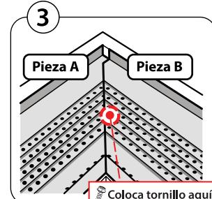
Así se ve una esquina terminada. La Pieza B debe reposar por encima creando un acabado liso. Para un instalación con mejor sellado, coloca un tornillo a través de ambas piezas.
