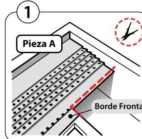
Recorta el borde frontal de la Pieza A, como se muestra en la primera imagen. Use los hoyos de drenaje como linea de corte. Esto permitirá que la Pieza B encaje encima de la Pieza A.
