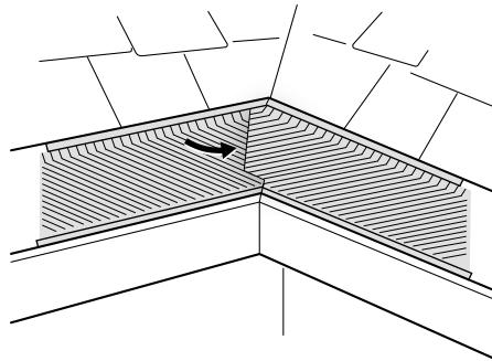
**INSTALA LOS PROTECTORES:** Coloca el primer lado de la esquina pre-cortada encima de la canaleta. Sobrepon el segundo lado encima del primero asegurándote que las dos secciones se emparejen en la esquina frontal de la canaleta. La malla tendrá un tramo de 2 pulgadas sobrante en el centro de la canaleta.
