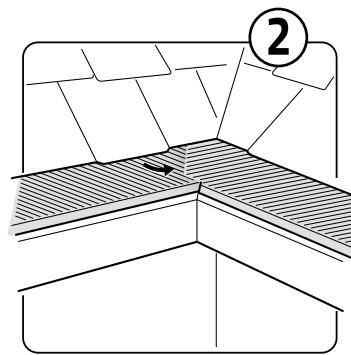
Repite el proceso para instalar el otro lado de la esquina. Asegúrate que ambos lados queden emparejados en la esquina frontal de la canaleta. La malla tendrá 2 pulgadas sobrantes al centro de la canaleta.
