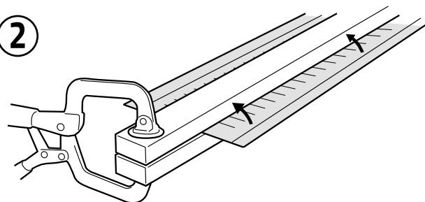
**DOBLA LA MALLA:** Dobla la malla hacia arriba o abajo, dependiendo de tu método de instalación, usando una dobladora comercial o de madera.
