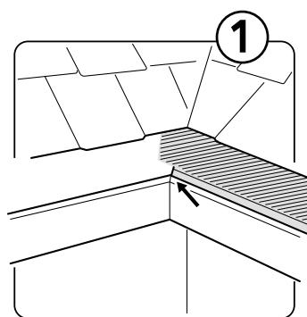
Levanta cuidadosamente las tejas delanteras y desliza el riel trasero de la sección esquina por debajo de la teja.
