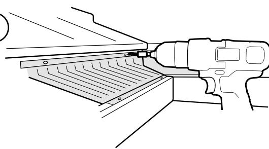
**ATORNILLA:** Una vez que ambas secciones estén colocadas en su lugar y debidamente anguladas, atornilla el riel frontal de cada sección al borde frontal de la canaleta. Atornilla el riel trasero, o la malla, a la fascia.
