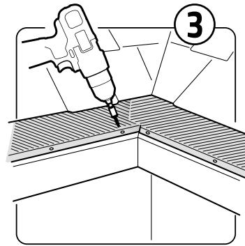
Una vez que ambas secciones estén en su lugar, atornilla los rieles frontales de cada sección al borde de la canaleta usando 2 chilíos por sección.
